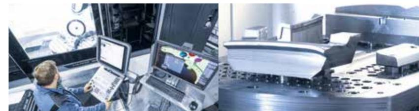
На больших фрезерных станках из литых заготовок изготавливают матрицы, прижимы и штампы. При производстве компонентов для штампов и пресс-форм заказчики Tebis повышают эффективность производства за счёт комплексной обработки и автоматизированного производства элементов.
