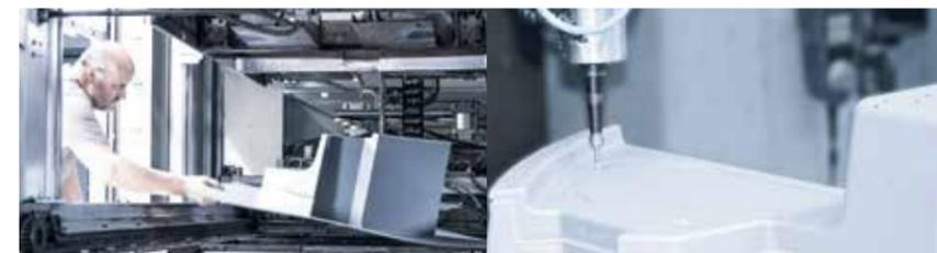
Термоформы необходимы для серийного производства пластиковых деталей. Программное обеспечение Tebis часто используется для обрезки контура после термоформования.
