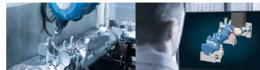
NC-симуляция траекторий, интегрированная в среду CAD/CAM, делает производство более надёжным и эффективным. Проверенные NC-программы являются необходимым условием для автоматизации и многостаночного обслуживания.
