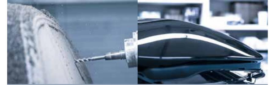
При дизайн-моделировании создаются модели из промышленного пластилина. Изготовленные части применяются далее, например в силиконовых формах для производства световых приборов.
