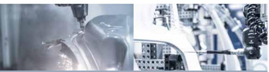
Для обрезки деталей из листового металла используются лазерные лучевые установки. Также и здесь используются специализированные технологии CAD/CAM Tebis. На координатно-измерительных машинах проверяется соответствие размеров изготовленных деталей из листового металла.
