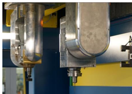
Комбинация оси «Z» с фрезерным шпинделем Classic 126 и второй осью «Z» с ультразвуковой режущей головкой.
