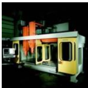
Станок с 2-мя вилочными головками и шпинделем GEISS для одновременной обработки 2-х деталей.
