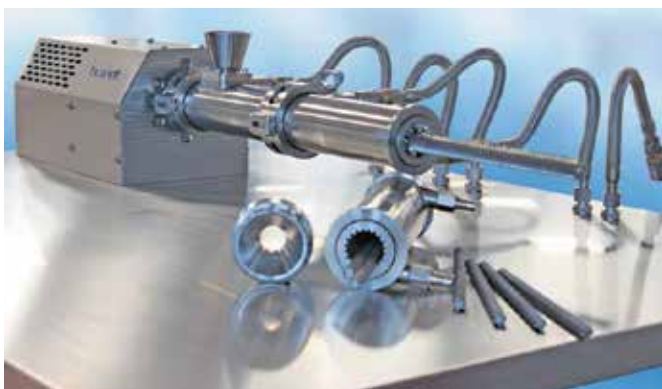
Рис. 5. Примеры компонентов, входящих в стандартную поставку экструдера L-WE 30
